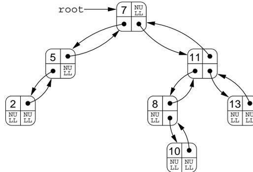
**Figura 16.11** Esempio di albero binario: ogni nodo contiene il dato da immagazzinare e tre puntatori che definiscono le sue relazioni di parentela. I dati sono stati inseriti nei nodi in modo da soddisfare la proprietà fondamentale di un albero binario di ricerca.
