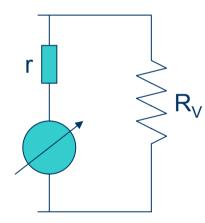
$$R_{\rm V} \qquad V_{\rm mis} = V \, \frac{r}{R_{\rm v} + r}$$
